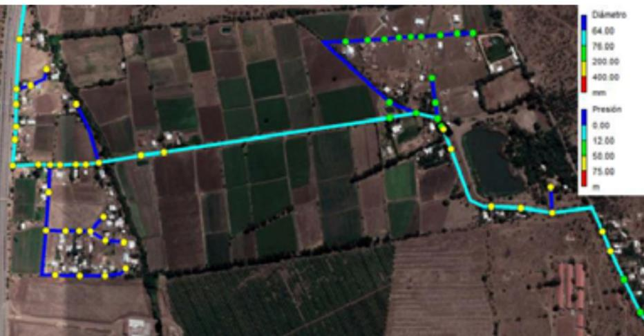
La ampliación del Agua Potable Rural (APR) considera la construcción de 100 nuevos arranques para 100 familias que actualmente no cuentan con un suministro confiable y continuo de agua potable (AP). Con el fin de estudiar la factibilidad hidráulica de dicha
